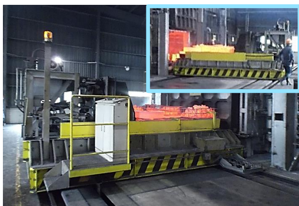
ていおん ろ や もど せいひん だいしゃ はこ 低温炉で焼き戻しをした製品を、台車で運びます。
