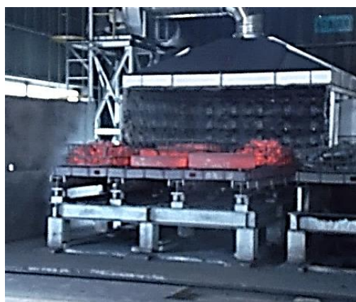
せいひん しぜん さ 製品を空気中で、自然に冷まします。
